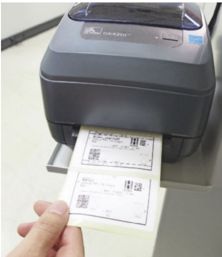
/ Der Etikettendruck lässt sich z. B. durch einen Bildschirm-Touch auf das jeweilige Teil starten.
