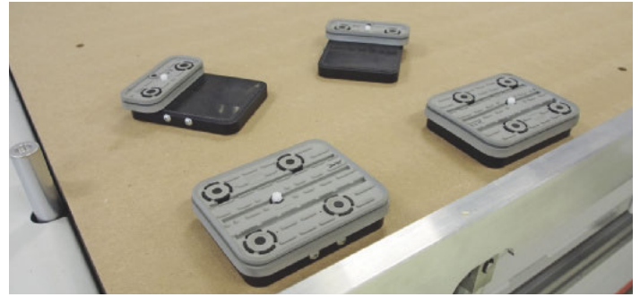
/ Auch ohne Vakuumschlauch guter Halt auf der Opferplatte: Für normale Bohr- und Fräsbearbeitungen können die Spannelemente einfach aufgelegt werden.
