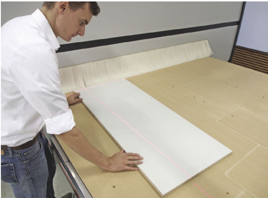
/ Direct-Cut: Diese pfiffige Funktion ermöglicht den schnellen und unkomplizierten „Schnitt“ zwischendurch. Linienlaser in x- und in y-Richtung visualisieren die Schnittlinie vor der eigentlichen Bearbeitung.
