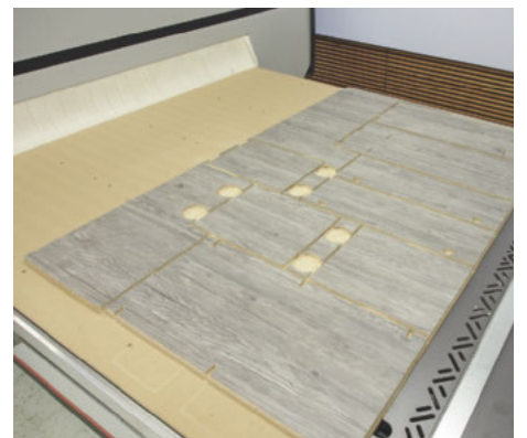
/ Das fertige Nest, noch nicht etikettiert. Die Teile müssen jetzt lediglich noch bekennt werden.
