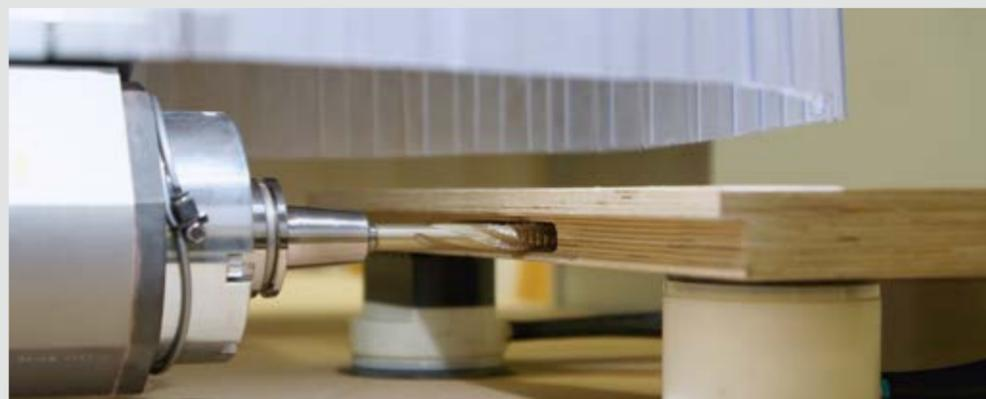
Maximale Flexibilität und perfekte CNC-Bearbeitung dank doppelt wirkender Sauger!
