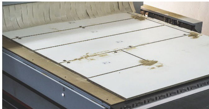
Diese Charge besteht aus Fronten mit Topfbandbohrungen. Die Korpusteile mit Cabineo-Einfräsungen sind bereits fertig
