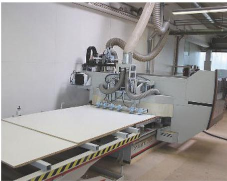
/ Vollautomatischer Nesting-Zyklus mit großformatigen Platten direkt vom Scherenhubtisch aus.
