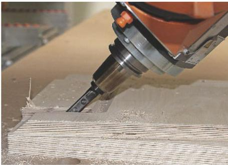
/ Das 5-Achs-Aggregat macht die Nesting-Maschine zur universell einsetzbaren CNC.
