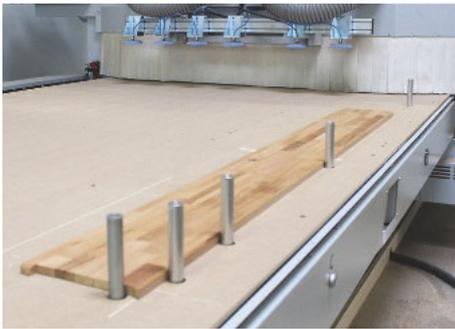
*/ Praktisch und schnell: Die versenkbaren Anschläge vereinfachen die Positionierung von Einzelteilen.*
