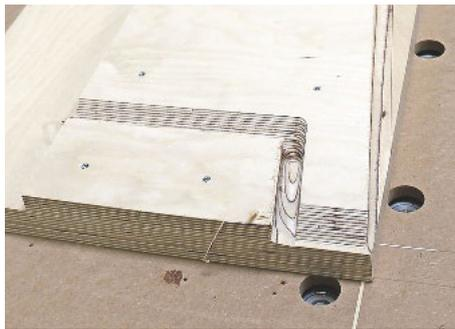
/ Einzelteile werden auf frei positionierbaren Blocksaugern oder auf einer zweiten Schonertafel gespannt.
