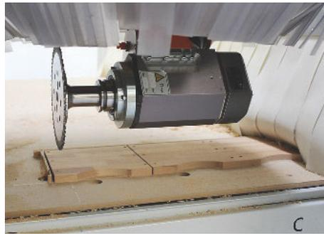
*/ Schubkästen aus Massivholz: Rationelle Mehrfachbearbeitung mit dem 5-Achs-Aggregat vom „Strang“.*
