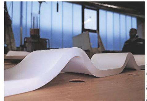
/ Mit Vakuumpresse und CNC kann Suppelt Formteile aus Holz und Kunststoff herstellen und bearbeiten.
